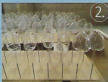
1. Skleněné polotovary 2. Po stlačení ve formě
