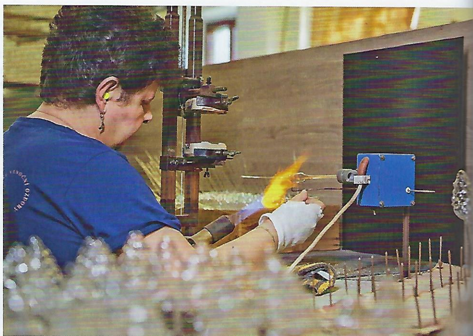
↑ SPECIÁLNÍ SKLO. Ručně foukané skleněné ozdoby se vyrábějí z tyčového skla s nízkým bodem tání. Základním tvarem pro výrobu ozdob je odtažek, ze kterého se fouká a tvoří vlastní podoba ozdoby buď volným tvarováním, nebo foukáním do forem.
