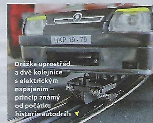
Drážka uprostřed a dvě kolejnice s elektrickým napájením – princip známý od počátku historie autodráh
